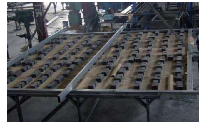
Imagen 30. Ejemplo de ensayo de Resistencia al viento.
