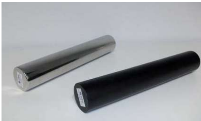
Imagen 29. Ejemplo de Probeta B para ensayo de dispositivos de protección
